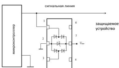
Защита несимметричной линии передачи данных с помощью модуля MKM015
